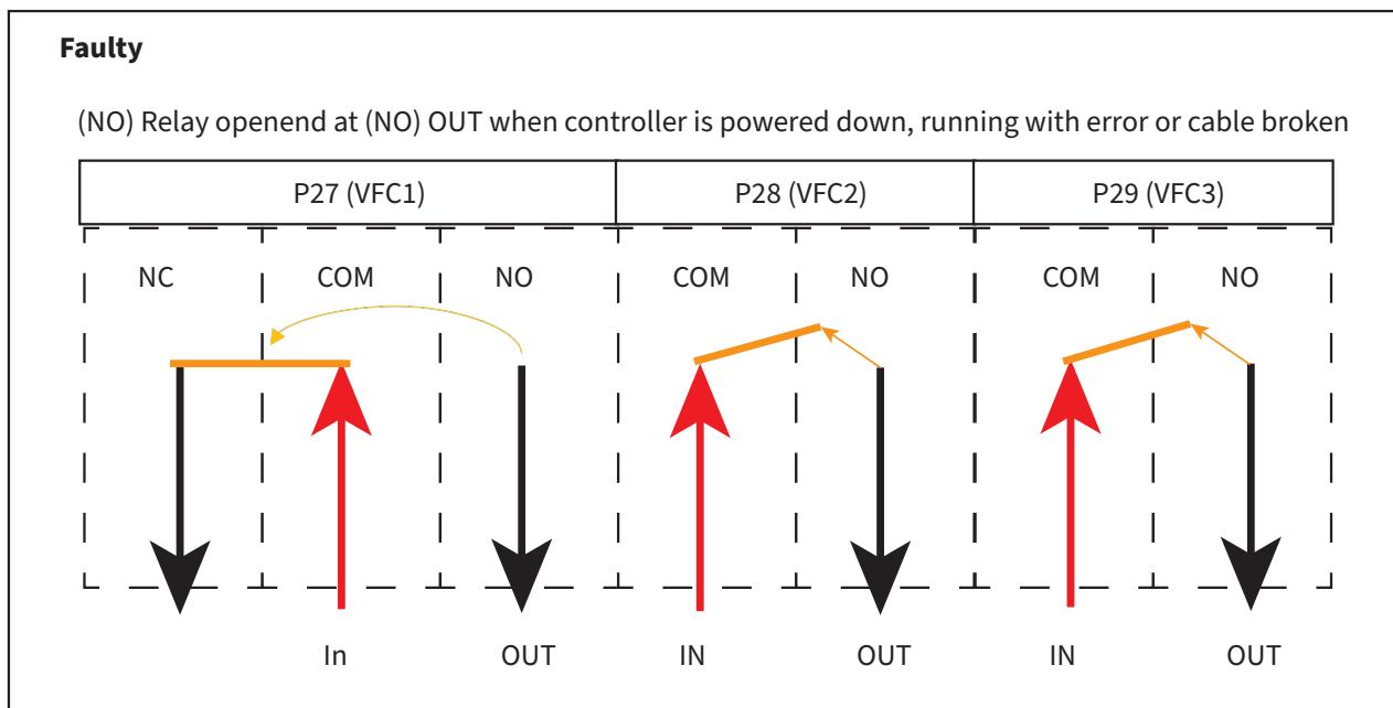
Служат для получения статуса автомата. Для каждого выхода можно назначать собственную неполадку. Выход P29 служит для передачи сигнала блокировки котла в режиме  $>110^{\circ}\text{C}$ , в этом режиме он не доступен для вывода аварийных сигналов.
