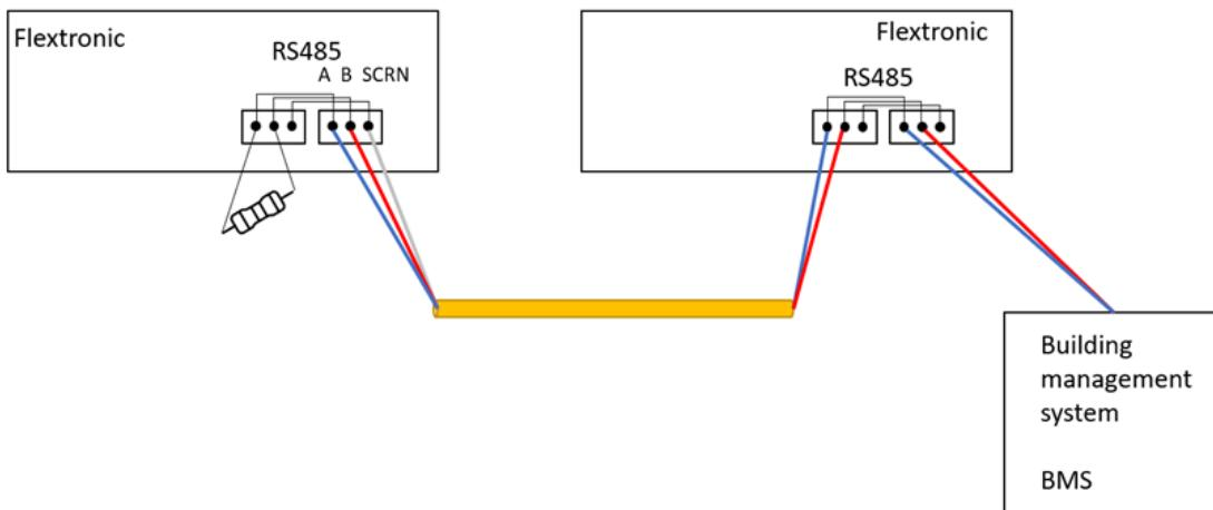
Шина RS-485 не поддерживает одновременную связь посредством Modbus и Bacnet. Если требуется оба протокола, для одного из них необходимо использовать Ethernet-соединение (IP).
