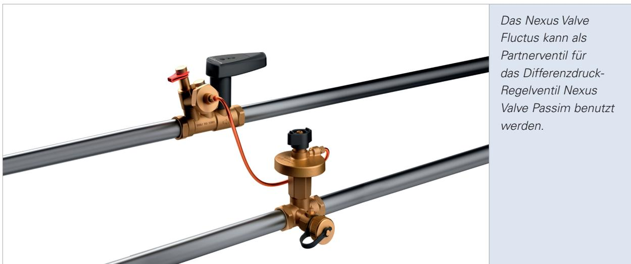
Das Kapillarrohr wird an den Entleerungshahn vor der Regelnadel des Nexus Valve Fluctus angeschlossen, wodurch sich das Ventil innerhalb des vom Nexus Valve Passim geregelten Systemkreises befindet. Der Druckabfall am Nexus Valve Fluctus muss dann bei der Einstellung des Differenzdruck-Regelventils Nexus Valve Passim berücksichtigt werden.
