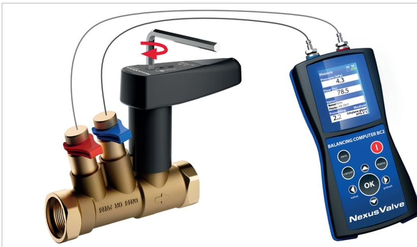
*Nexus Valve bietet einen speziellen Abgleichcomputer an, in dem alle Nexus Valve Ventildaten gespeichert sind. Zur Differenzdruckmessung werden Schläuche mit Nadeln an den Messpunkten des Nexus Valve Fluctus angeschlossen. Dieser Messwert kann im Abgleichcomputer in einen Durchflusswert umgerechnet werden.*
