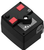
Für direkten Aufbau auf den Mischer. Mit Steckernetzteil 230V~, 50 Hz Laufzeit 140 s / 90°, Drehrichtung umkehrbar; 6 Nm. 4 Einstellbereiche 0 ... 95 °C, digitale Sollwerteneinstellung und Temperaturanzeige, Not-Handbetrieb, Stellungsanzeige; Temperaturfühler ø 6 x 25 mm mit 1m Kabel, fest verdrahtet.
