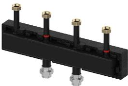
(Achsabstand 200mm, für Wandmontage) EPP-Isolierung, mit 2 oder 3 Anschlusspaaren nach oben (1 1/2" Überwurfmutter flachdichtend), 1 Anschlusspaar nach unten (2" Überwurfmutter flachdichtend mit Einschraubteil 2" M x 1 1/2" F), zum Aufbau der Pumpengruppen V-UK, V-MK; komplett mit den notwendigen Verschraubungs- und Anschlussteilen, Zwei 1/2"-Muffen seitlich für z.B. KFE-Hähne, für Leistungen bis 100 kW (bei ΔT=20 K bzw. max. 4,5 m³/h bei vertretbarem Druckverlust).
