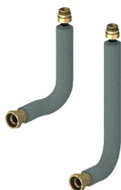
Zu jedem Anschlusset empfehlen wir ein Verbindungsset zwischen Sammler und Heizgerät bzw. Pumpe. Die Verrohrung erfolgt mit 2 gedämmten Edelstahl-Wellrohren DN 32 mit 0,7 m und 1 m Länge. Die Wellrohre werden mit den beiliegenden Überwurfmuttern 2" an den Sammler geschraubt, gemäß den örtlichen Gegebenheiten gebogen und auf das passende Maß gekürzt. Fixlock-Verschraubungen mit 1 1/4" M dienen dem Übergang auf Kugelhähne bzw. zum direkten Anschluß an das Heizgerät.
