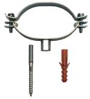
Ovalschellenset bestehend aus einer Ovalschelle zur Fixierung des inflex-Edelstahlwellrohres in Doppelstrangisolierung DN 16 und DN 20 inkl. Stockschraube M 8 × 80 und Dübel.
